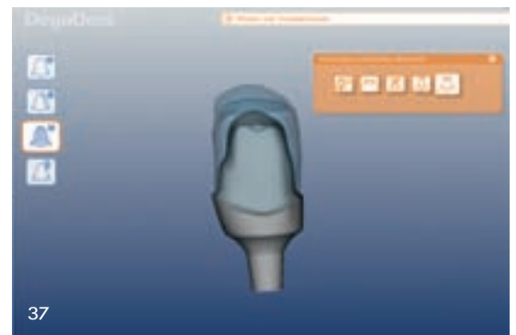
Abb. 34 bis 37 Die Software errechnet anhand des Set-up die optimale Form des Implantataufbaus. Abbildung 34 zeigt die Justage für den Scanner
